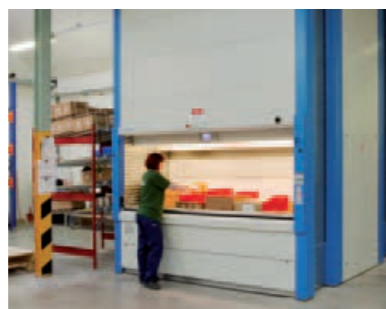
KARDEX. Veľkokapacitný automatizovaný skladovací systém.
