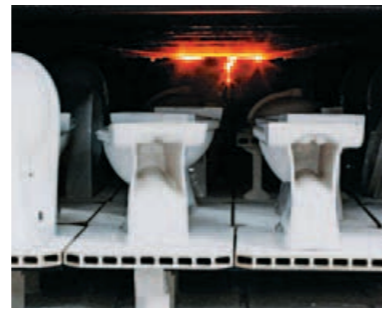
Usušené a glazované výrobky sa vypaľujú pri teplote až 1240 °C.
